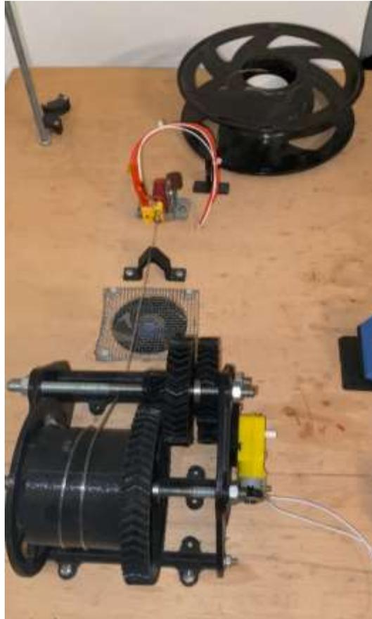
**Elaborado por: El autor, 2024****Figura 13****Filamento resultado de la extrusión del PET reciclado**
